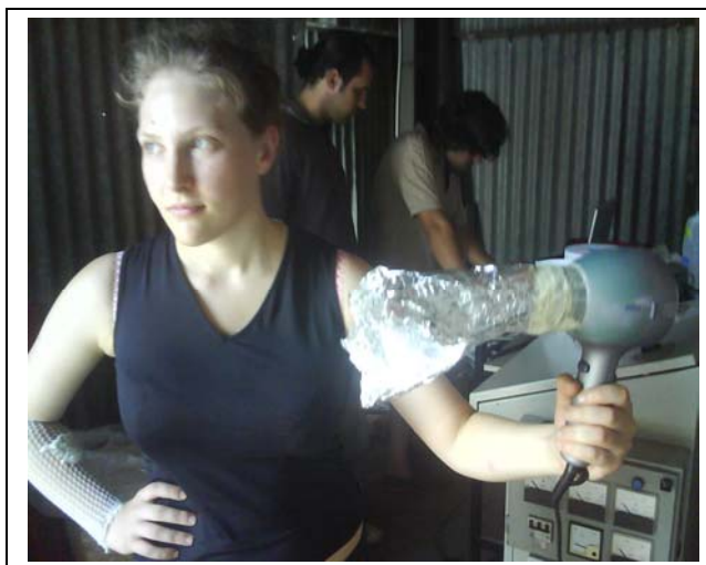
Installation de matériel chauffant, la feuille d'aluminium a pour but d'isoler thermiquement le sèche cheveux.
